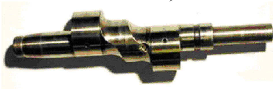
شكل ٥- ٣: عمود إدارة لامركزي لمحرك ذي مكبسين دوارين
